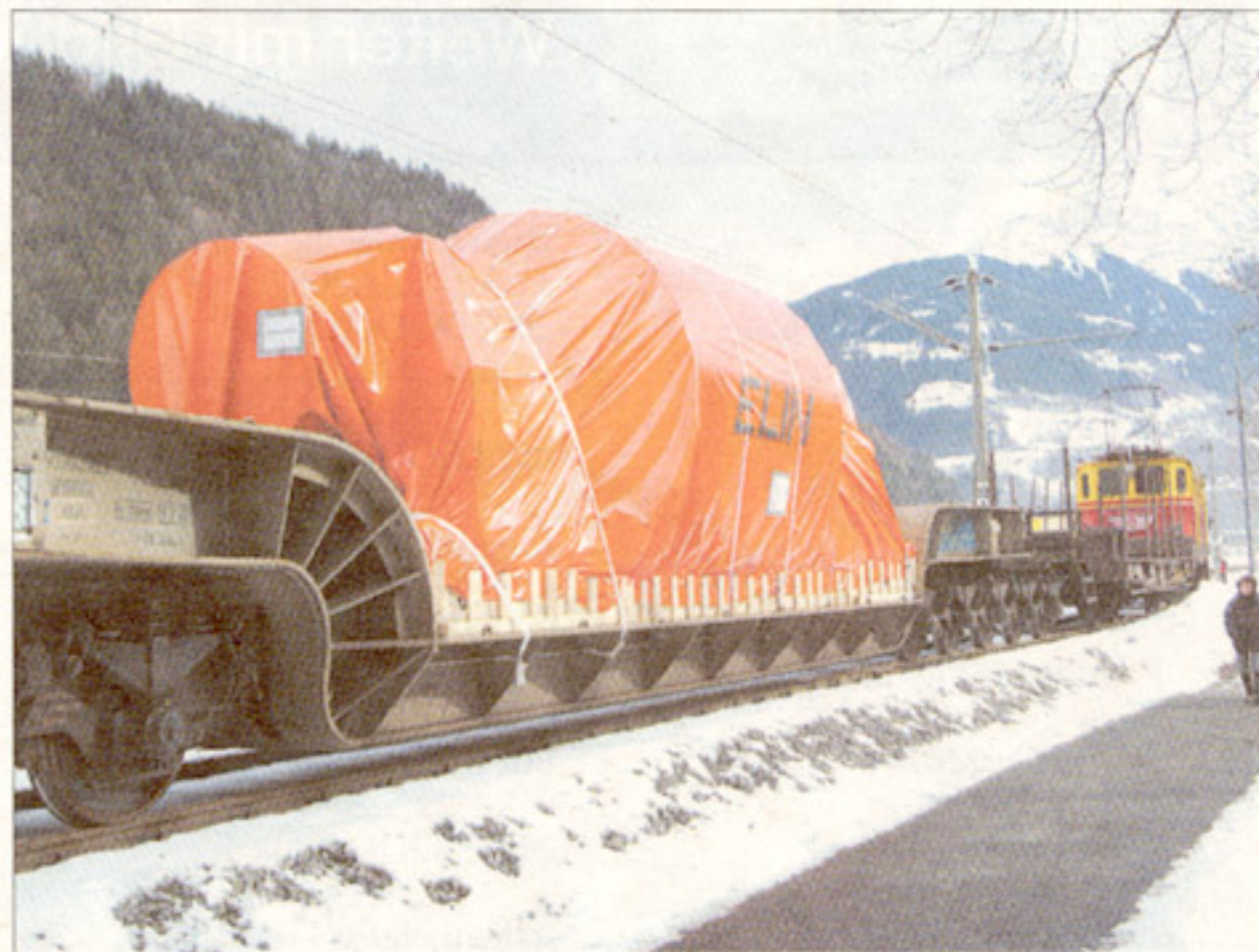
125 Tonnen wiegt der Rotor, der in die Maschine 3 des Kopswerk II eingebaut wird.
